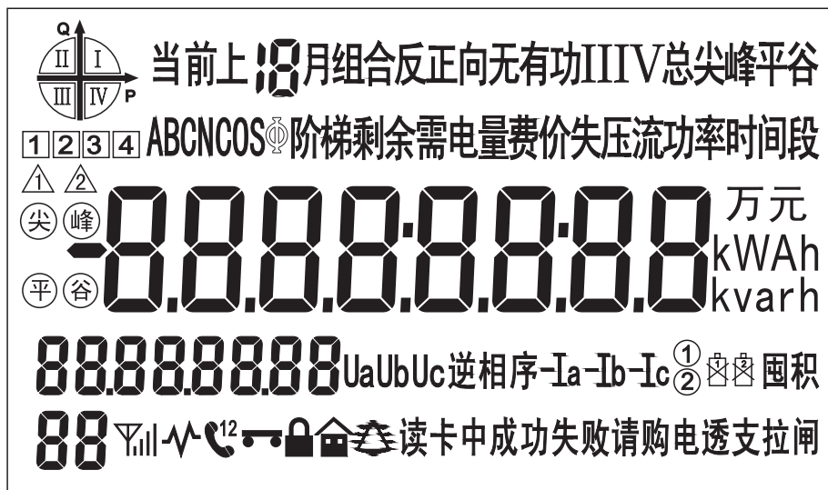
图5-1 三相智能电能表LCD显示界面参考图
